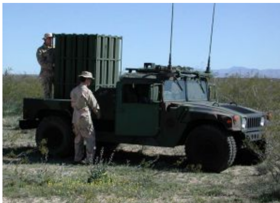
Контейнерът за изстрелване CLU на ракетите РАМ и LAM, монтиран на многоцелевата машина „Хамър” - HMMWV
