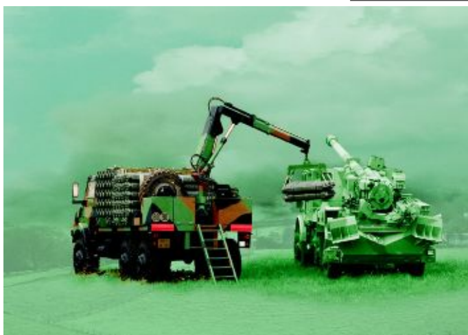
Действие на транспортнозареждаща машина от системата „Цезар”
