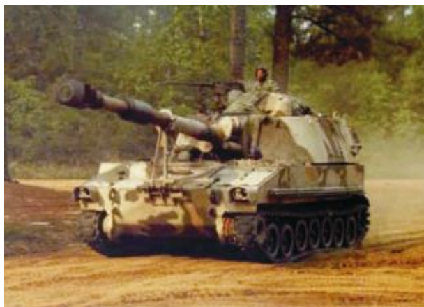
155-мм самоходна гаубица M109A5 „Паладин”
