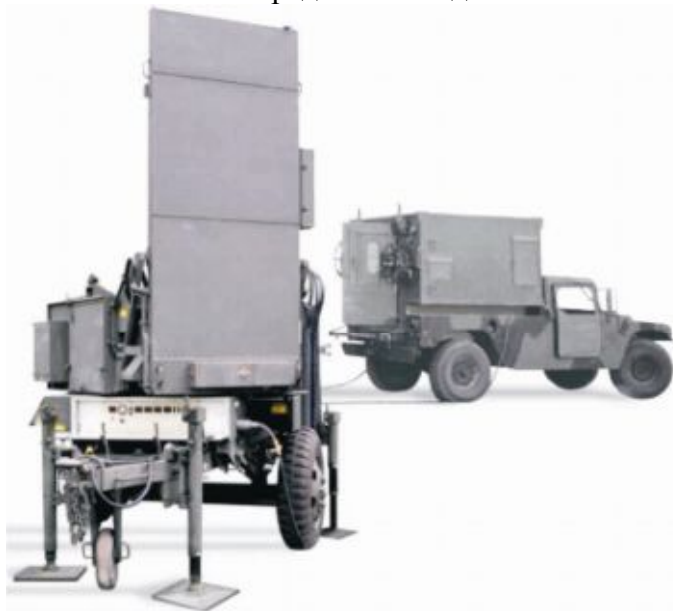
РЛС AN/TPQ-36 за разузнаване на стрелящи огневи системи
