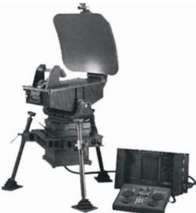
РЛС „RATAC-S” за разузнаване на движещи се наземни и морски цели
