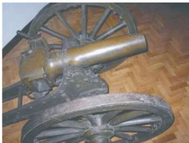
3-фунтово планинско руско бронзово оръдие M1867 (кал. 76,2-мм), Военноисторически музей
