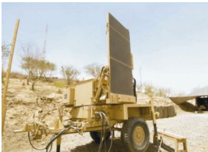
РЛС AN/TRQ-37 за разузнаване на стрелящи огневи системи
