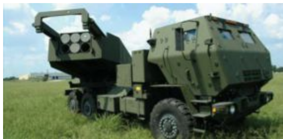
„BAE Систъмс“ произвеждат кабина с повишена защита на разчета на „Хаймарс“
