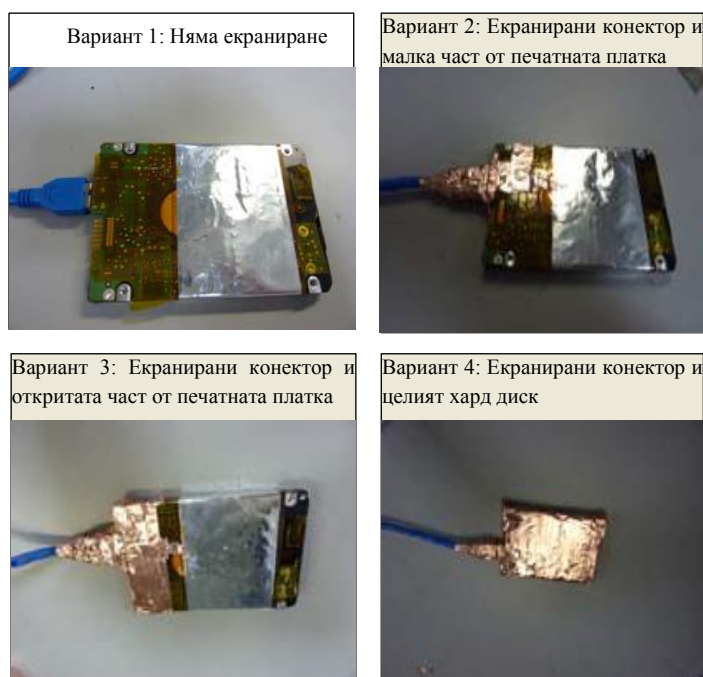
Фигура 3.1. Варианти за екраниране на USB 3.0 външен хард диск
