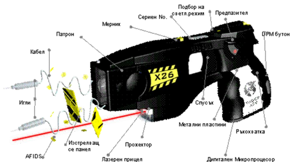
Фиг.13 Елементи на електрострелящо оръжие Тейзър X26.
