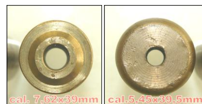
Фиг. 13. Изглед през дулото на цев №1 с калибър 7,62x39 mm и цев №2 с калибър 5,45x39,5 mm
