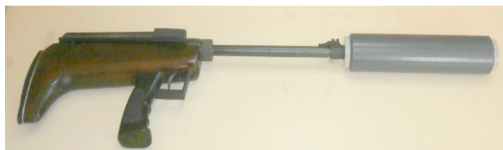
Фиг. 4. Самоделно преработена пневматична пушка „МЕТЕОР“, модел QB57, пригодена за стрелба с патрони калибър 5,5 mm (22LR) със заглушител.
