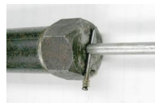
Фиг.17. Ударен механизъм от прост тип.
