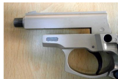
Фиг. 2. Цев и рама на газово сигнално пистолет "ZORAKI" – модел 914, калибър 9 mm P.A.K..
