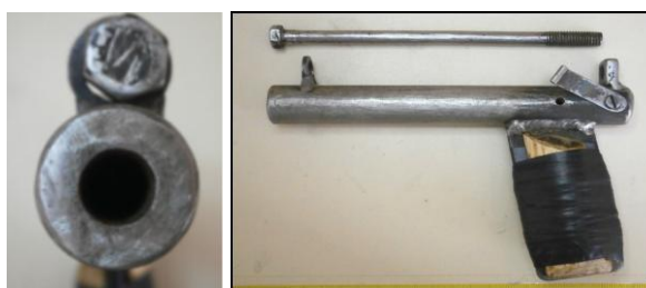
Фиг.11. Самоделно устройство с металния шомпол за зареждане.
