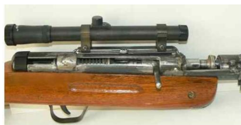
Фиг. 3. Самоделно преправена пневматична пушка калибър. 5,5 mm.
