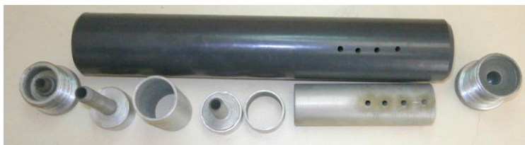
Фиг. 6. Представеният самоделен заглушител в разглобен вид.
