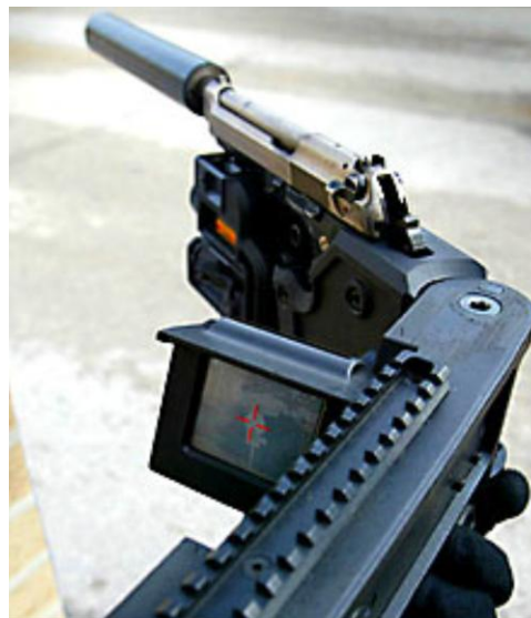
Фиг.6. Система за стрелба под ъгъл „Corner Shot”.
