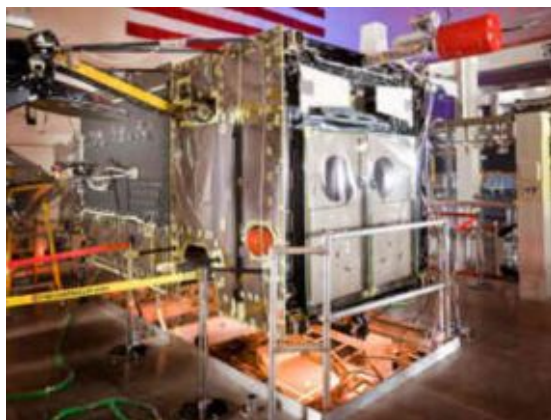
Сглобяване на компонентите на SBIRS GEO-1
