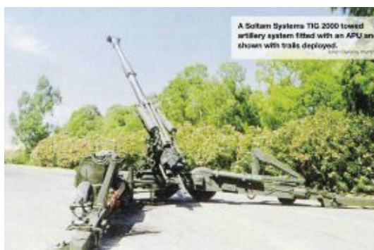
155-mm буксирна артилерийска система TIG 2000 на „Солтам Системс“, снабдена със спомагателна силова установка
