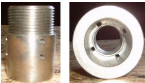
Фиг. 3. Корпус на учебния взривател (запалка)
