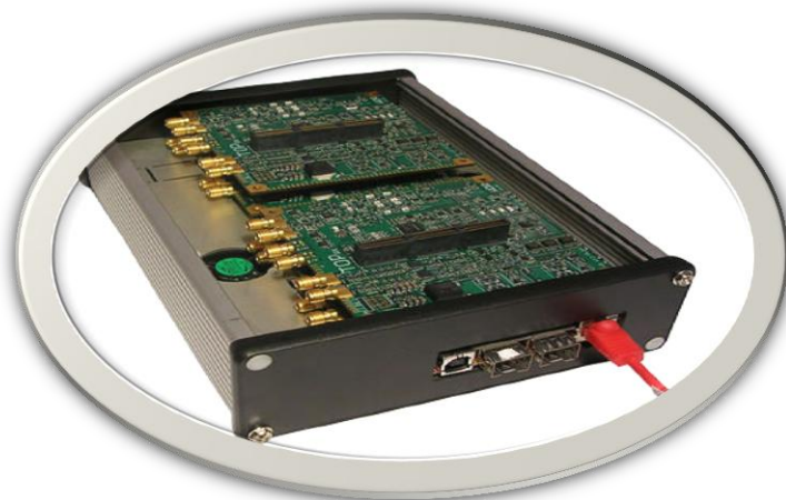
Фигура 1. SDR радиоустройство
