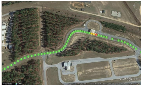
Фиг. 1: Локализация на излъчвател чрез определяне интензитета на електрическото поле
