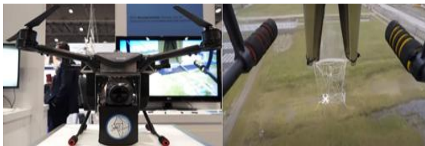
Фиг. 6. Външен вид на SkyWall и улавяне на БЛА с мрежа
