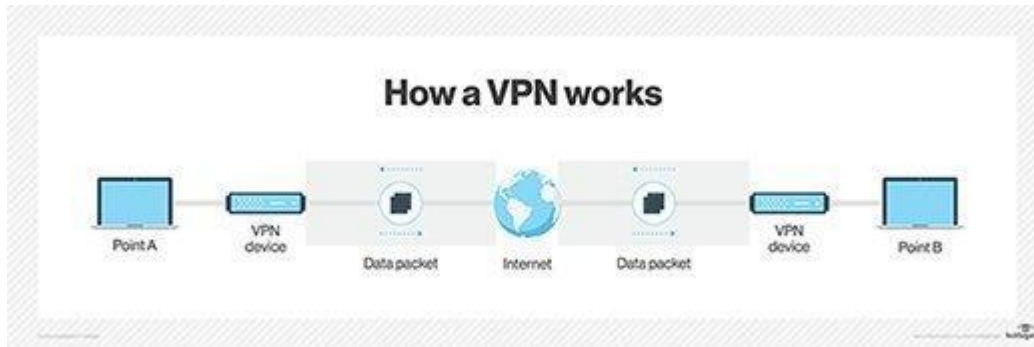
Фиг. №1 – Схема на работа на VPN
