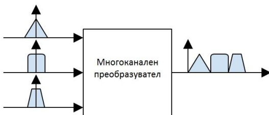
Фиг. 6. Принцип на действие на многоканален преобразувател.
