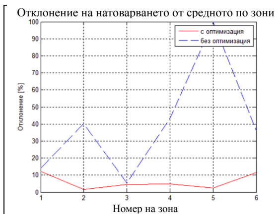
Фиг. 11. Средноквадратично отклонение на натоварването на зоните (%) от средното натоварване при \lambda = 80 вс/ч: преди прилагане на МП – 54,7819%, след прилагането му – 8,2119%
