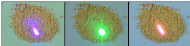
Фиг. 1 б) Облъчване на RDX с кохерентни източници с дължина на вълната \lambda = 430\text{ nm} , \lambda = 530\text{ nm} , \lambda = 630\text{ nm} .
