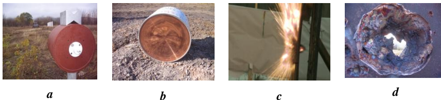
Фигура 1. Етапи на експлозивно формиране на ядрото и ударното взаимодействие с целта
