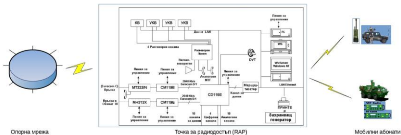
Фиг. 1. Място и състав на RAP в мрежа за радиодостъп на система ПИКИС 61 мбр.
