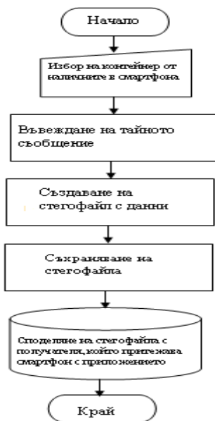
Фигура 4. Блок схема за вграждане на конфиденциална информация в реално време и споделянето ѝ чрез смартфон
