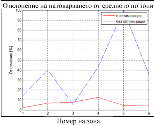
Фиг. 17. Средноквадратично отклонение на натоварването на зоните (%) от средното натоварване при \lambda = 80 вс/ч: преди прилагане на МП – 54,7819%, след прилагането му – 8,0072%
