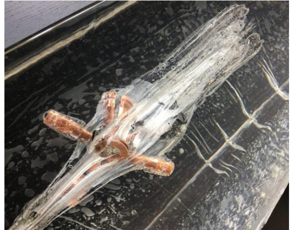
Фиг. 8: OATH 12 GA TSR изтрелян в балистичен гел.
