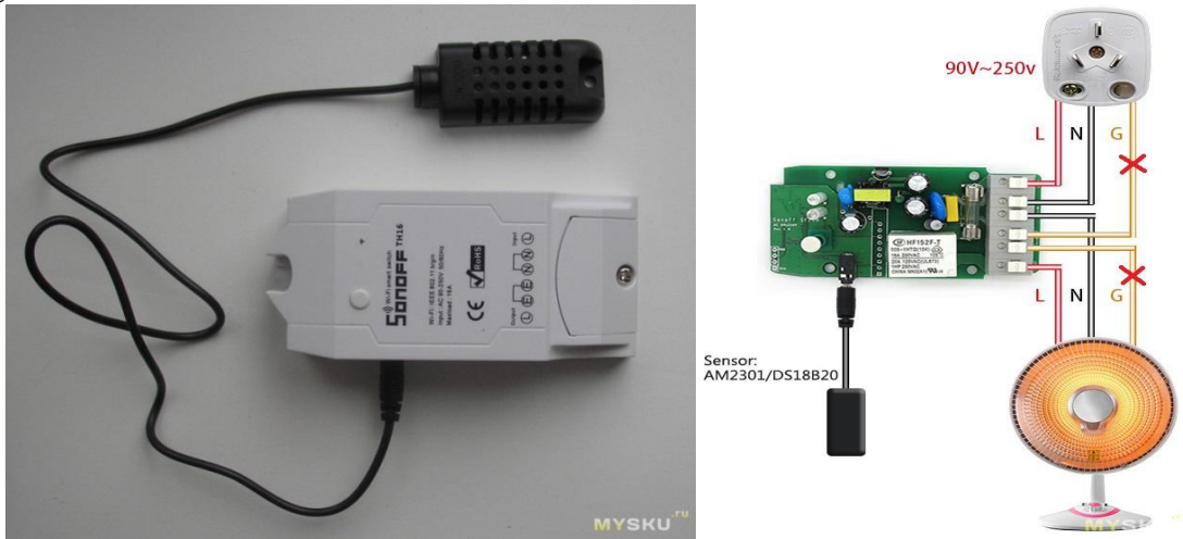
Фигура 1. Външен вид и електрическа схема на Sonoff TH 16 [2]
